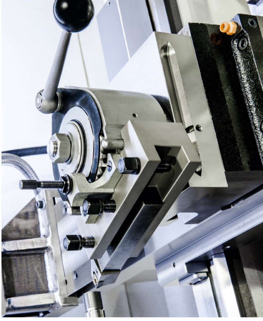
Die profilleschliffene Verzahnung ermöglicht 40 verschiedene Winkelstellungen
