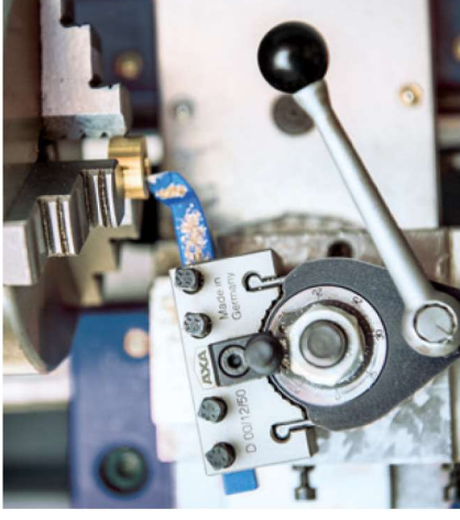
Drehstahlhalter D00/12/50 während der Bearbeitung
