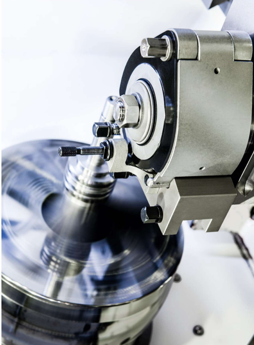
Drehstahlhalter D während der Bearbeitung
